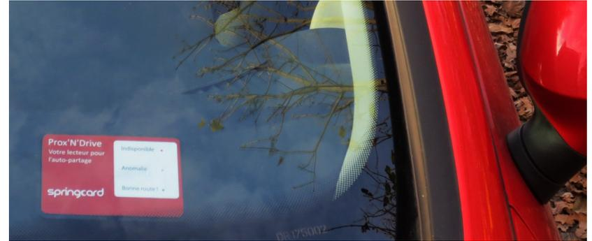
Le Prox'N'Drive est un lecteur créé pour être installé derrière la pare-brise d'une voiture. Son antenne a des réglages spécifiques, pour prendre en compte la perméabilité magnétique du verre.
