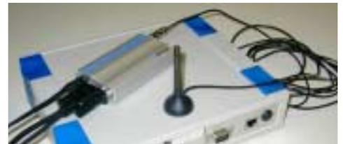
Au format 1/2 rack, le **serveur CAMPI-Key Web** s'intègre aisément dans vos armoires techniques et fédère jusqu'à 32 centrales (soit 128 portes)
