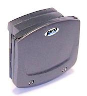
Le **SpringCard-CF** de **Pro-Active** est un lecteur de cartes à puce utilisable dans la plupart des PDAs PocketPC disposant d'un connecteur au format Compact-Flash.
